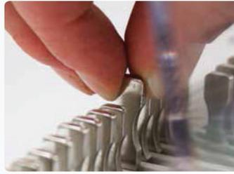
Die QSA-Technologie (Quick Size Adjustment) erlaubt das sekundenschnelle Ausschalten der Stanzstempel, wodurch Papierformate einfach und schnell gewechselt werden können.
