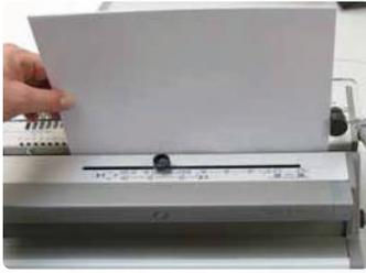
Vertikales Stanzen erhöht die Präzision beim Stanzvorgang.
